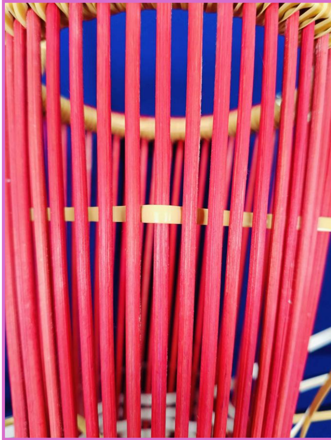
ภาพที่ ๓.๓๖ การสานข้าม “ข้ามหลัก” หรือการข่มหลัก
