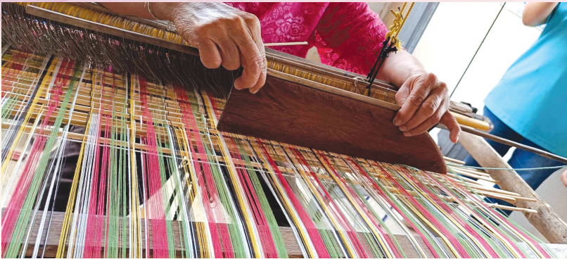
วางไม้ดาบสั้นบนด้ายยืน / วางไม้ผูกเขabanสั้นไม้ดาบ
