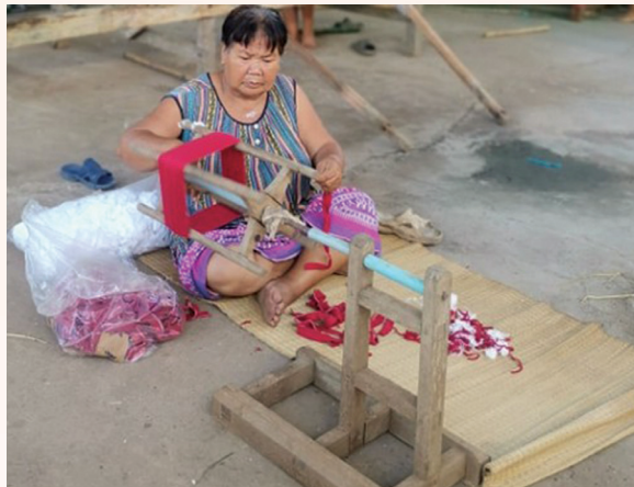
ดึงเส้นด้ายออกจากปกเสื้อโปโลออกมาเข้าที่กวดด้ายก่อนที่จะนำไปเข้า ระวียงหรือกงปั่นด้ายเพื่อให้เส้นด้ายมีความหนาขึ้น
